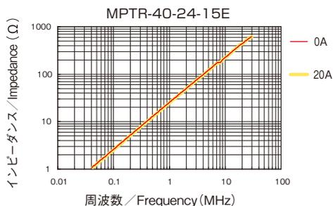
※測定条件: インピーダンス測定側: 5ターン、直流電流重畳側: 1ターン
