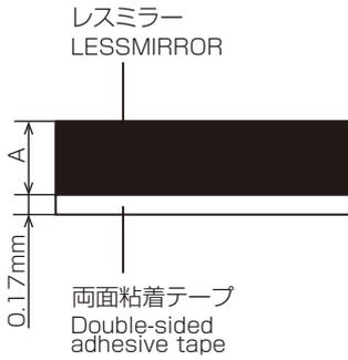
薄型・軽量のGHz用ピンポイント型電波吸収体
