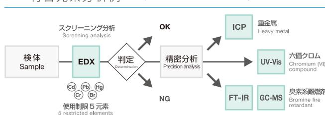
北川工業では有害元素分析装置を導入し、お客様に安心してご使用いただける製品の供給に努めています。
