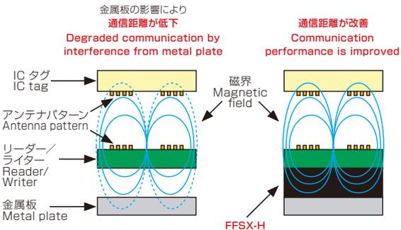
アンテナ間の結合損失 / Coupling loss between antennas
